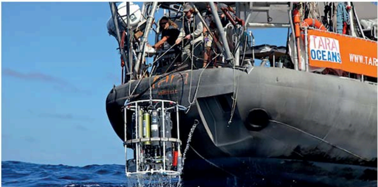
Mise à l'eau de la rosette (©S. d'Orgeval/FondationTaraExpeditions)
