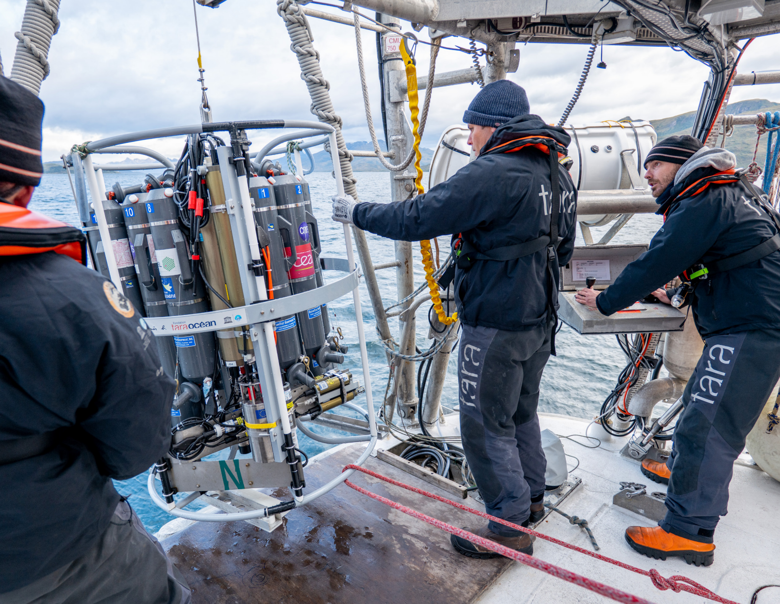
© Maéva Bardy - Fondation Tara Océan - Déploiement de la rosette CTD (conductivity temperature depth) à bord de la goélette Tara
