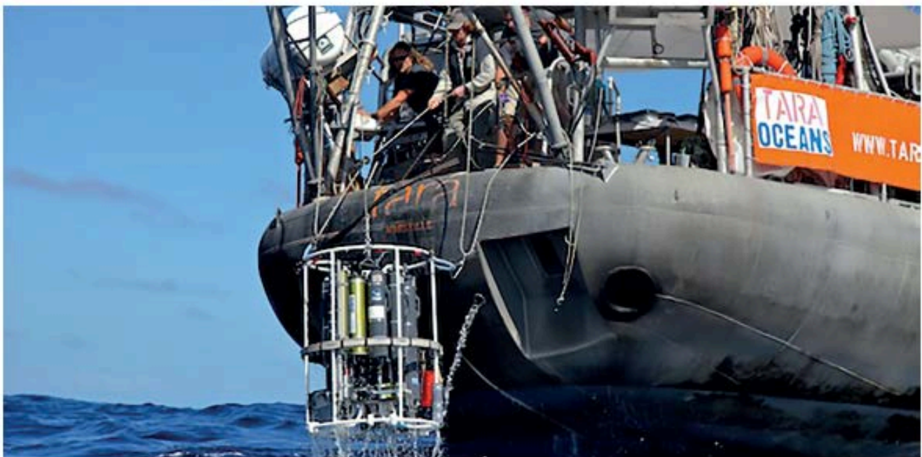
Mise à l'eau de la rosette (©S.d'Orgeval/FondationTaraExpeditions)
