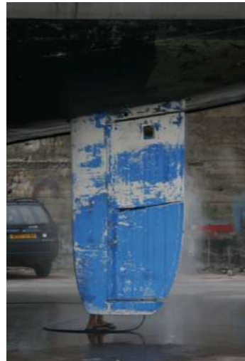
© Fondation Tara Océan Nettoyage d'un des safrans de Tara en position basse. Le bateau est hors de l'eau. Les deux volets du safrans sont sous la coque.
