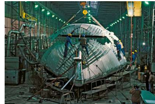
© Francis Latreille / Fondation Tara Océan Coque de Tara retournée lors de sa construction.
