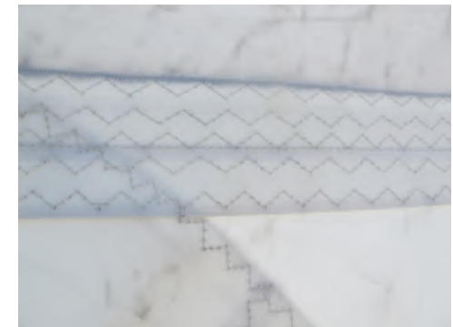
© François Aurat / Fondation Tara Océan Couture de la jonction de trois laises en Dacron® d'une voile de TARA. On peut voir sur la photo des marques d'usure de la voile.
