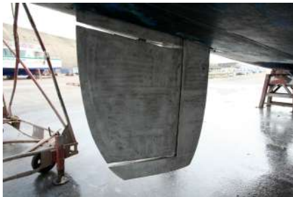
© Fondation Tara Océan Safran en position intermédiaire. Seulement un des deux volets est sous la coque.
