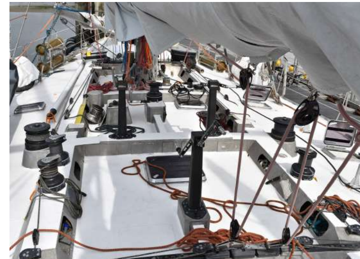
© Caroline Ovia / Fondation Tara Océan Zone de manoeuvre de voiles entre les deux mâts. On y trouve de nombreux winchs dont certains sont actionnés par les «moulins à café» (au centre).
