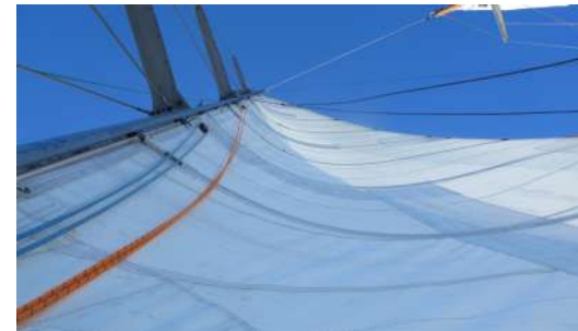
© François Aurat / Fondation Tara Océan Grand voile vue du dessous. On voit sur la photo la forme et le «creux» de la voile.
