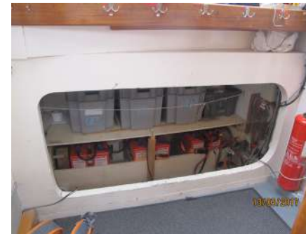
© François Aurat / Fondation Tara Océan Parc batterie dans la coursive entre l'atelier et le carré.
