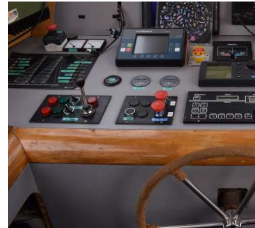
© Caroline Ovia / Fondation Tara Océan A gauche du poste de pilotage, les boutons d'arrêt d'urgence permettant de couper les ventilateurs de la salle des machines.
