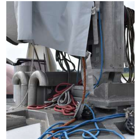
© Caroline Ovia / Fondation Tara Océan Tuyaux de sortie de l'air de la salle des machines sur le pont au niveau du pied de mât de misaine.
