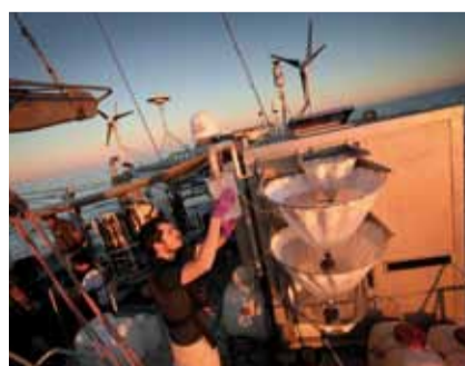
6. Une autre partie de l'eau est filtrée par un système de filets superposés de différents maillages avant d'être filtrée une nouvelle fois à l'intérieur du laboratoire humide.
