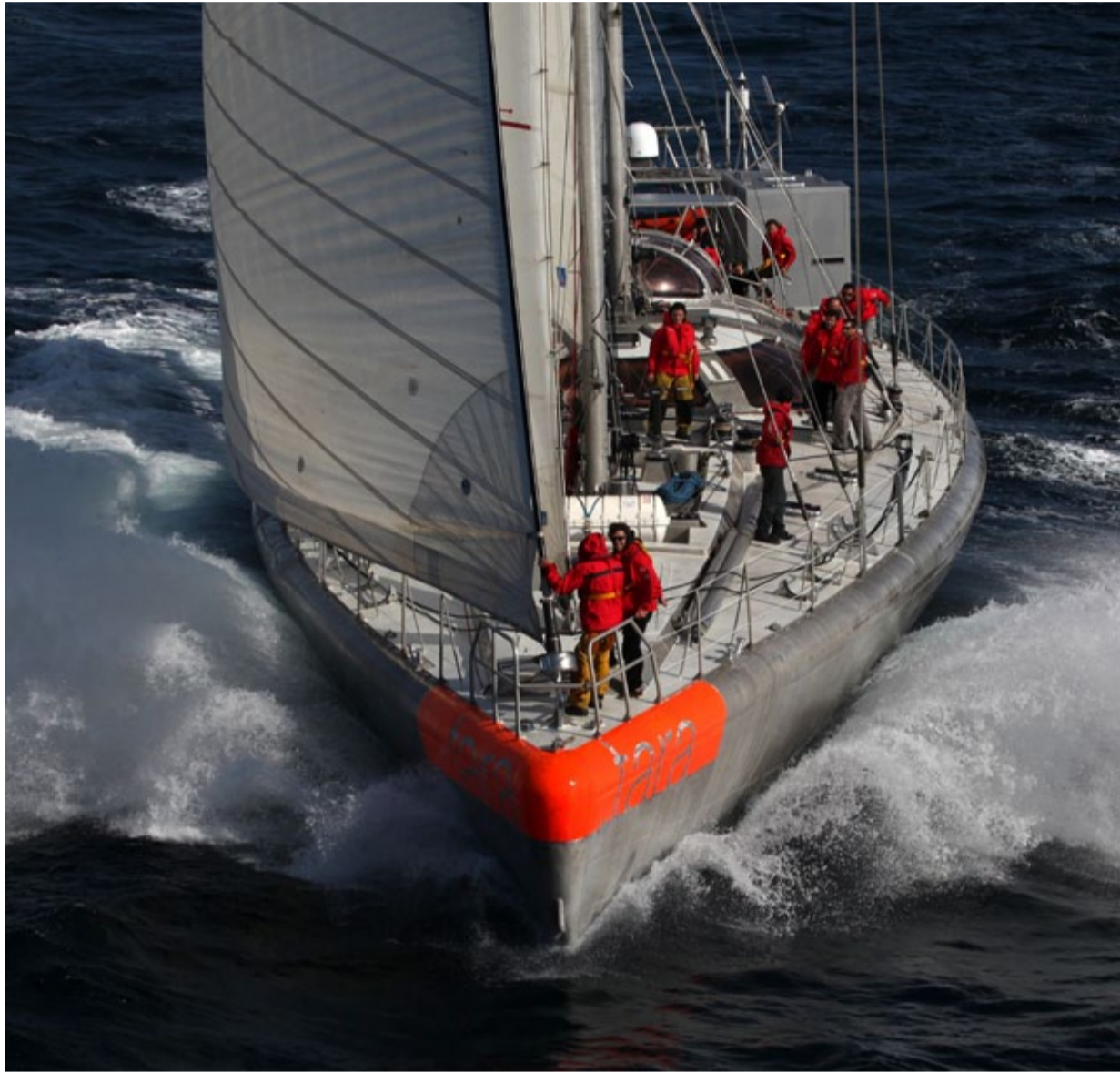
La goélette de 36 mètres a été conçue pour résister à la compression des glaces et aux très basses températures. - © F.Latreille/Fonds Tara
