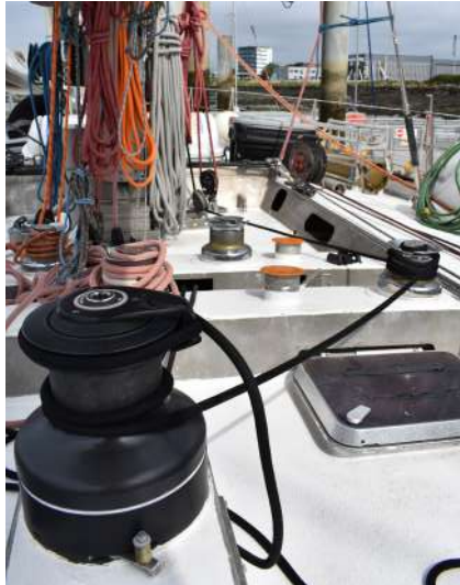
© Caroline Oviat / Fondation Tara Océan Winch avec cordage renvoyé par un drum.
