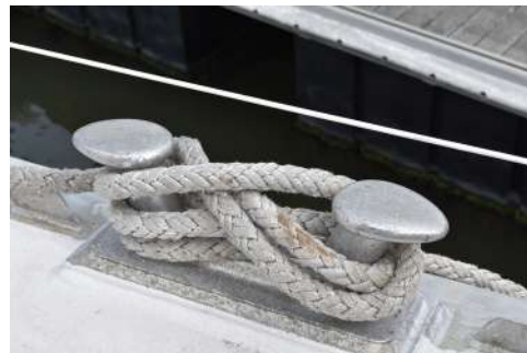
© Caroline Ovia / Fondation Tara Océan Aiguille bloquée sur un taquet.
