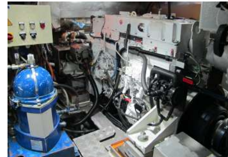
© François Aurat / Fondation Tara Océan Moteur tribord de Tara (en blanc à droite sur la photo). A gauche, la centrifugeuse permettant de filtrer le gasoil en sortie des réservoirs.
