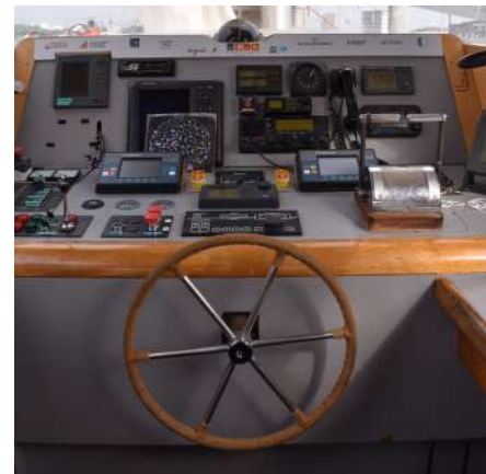
© Caroline Ovia / Fondation Tara Océan Poste de pilotage avec barre à roue et joystick pour diriger le bateau.
