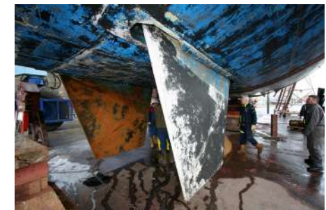
© Fondation Tara Océan Dérives de Tara. En pivotant elles rentrent dans le puit au-dessus d'elles.
