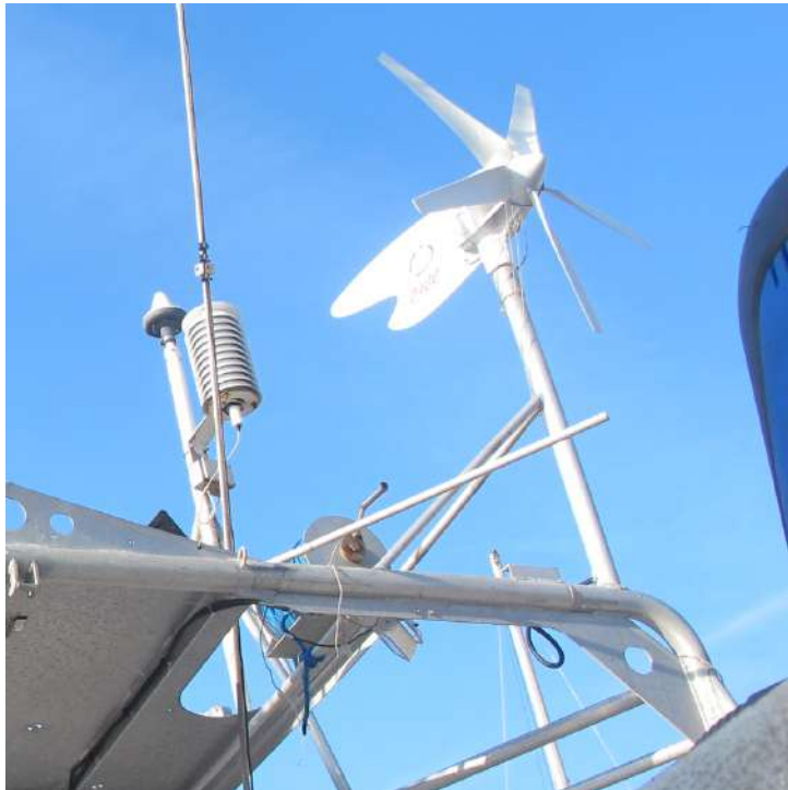
© François Aurat / Fondation Tara Océan Éolienne sur le portique arrière de Tara.
