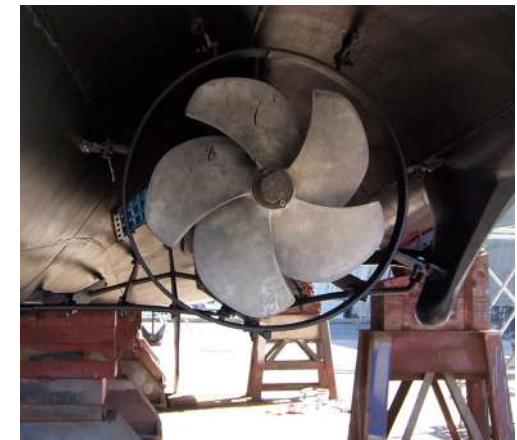
© Matthieu Weber / Fondation Tara Océan Hélice tribord avec croc en aluminium plein sur le côté et grille de protection.
