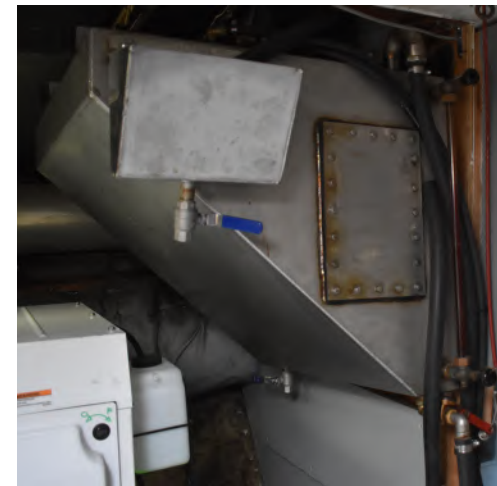
© Caroline Ovia / Fondation Tara Océan Caisse journalière de gasoil de la calle arrière avec jauge de niveau.
