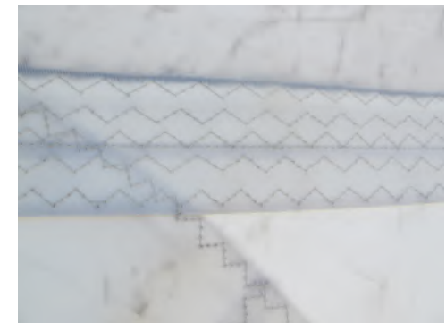
© François Aurat / Fondation Tara Océan Couture de la jonction de trois laises en Dacron® d'une voile de TARA. On peut voir sur la photo des marques d'usure de la voile.
